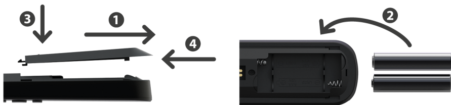
Figura 2: Inserire le batterie
