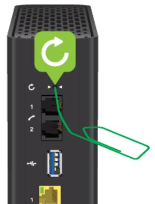
versenkte **Reset**-Taste auf der Rückseite des Gerätes.
